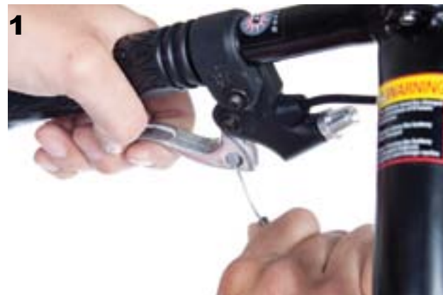
El extremo del cable encaja en el chasis de la palanca.
