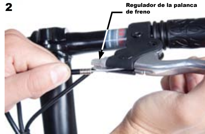
El cable pasa a través de la palanca de freno. Tenga en cuenta el hueco en el regulador que permite que el cable pase a través de él.
